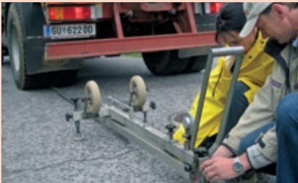
Grundlage dieses Erhaltungsmanagements ist eine visuelle Zustandserfassung der Straßenanlagen und Nebenflächen (Parkflächen, Geh- und Radwege etc.) sowie messtechnische Prüfung der Tragfähigkeit (siehe Bild), weil erst auf dieser Basis die technisch optimalen Maßnahmen zum richtigen Zeitpunkt gesetzt werden können.
